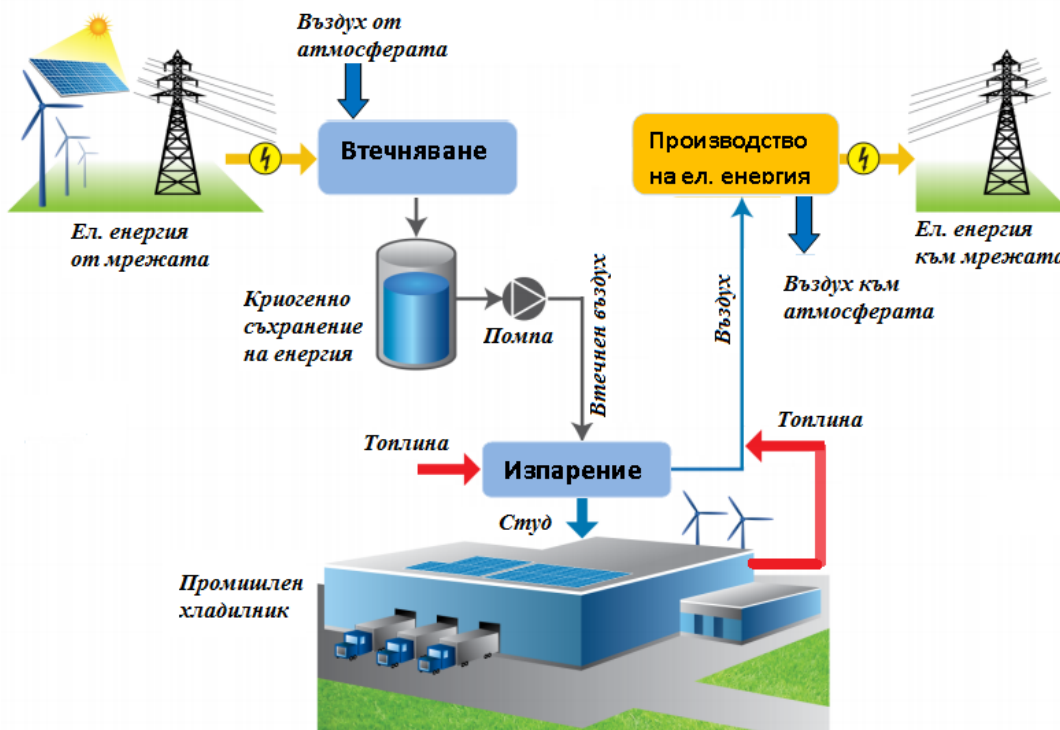
Фиг. 1. Синергична експлоатация на система за КСЕ и промишлен хладилник [2, 3].
