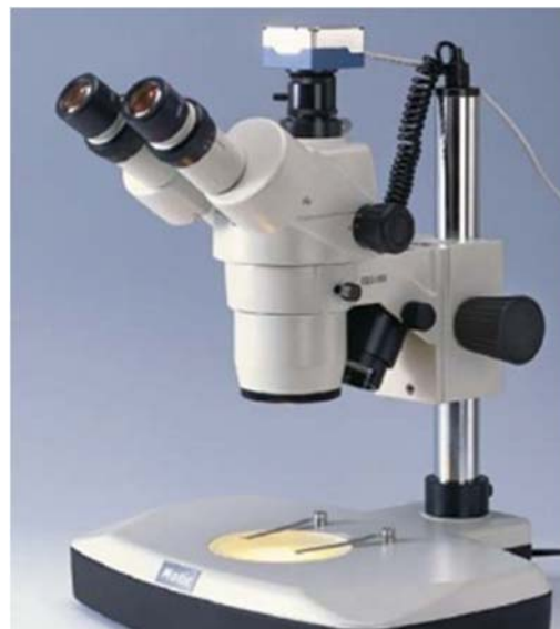
Фиг. 1 Общ вид на бинокулярен микроскоп и камера Moticam 2300
