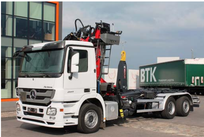
Фиг. 8 Товарен камион с товароподемен кран и товарач с кука за горската промишленост
