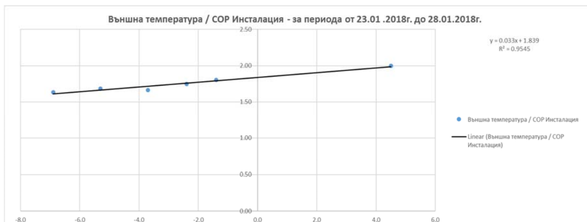
Фигура 6. Функционална зависимост на COP на системата от външната температура при площ на радиационният изпарител 3,2 \text{ m}^2 (измервания за периода от 23.01.2018 г. до 28.01.2018 г.)
