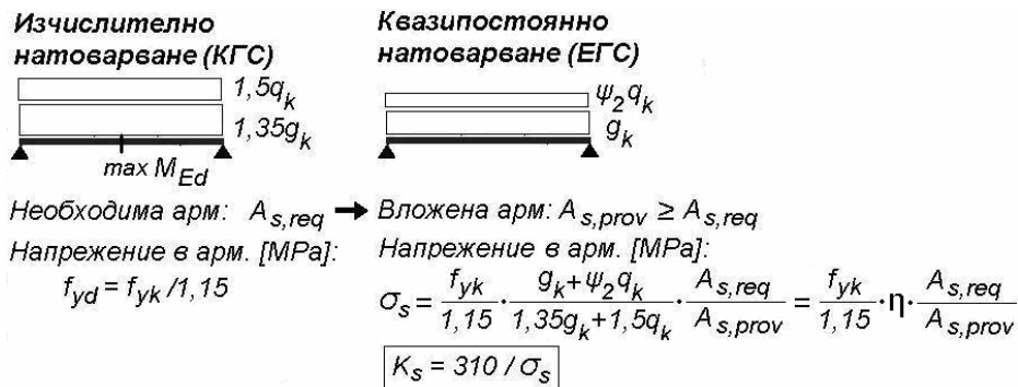
Фиг.8.4. Коефициент за напрежение в армивката K_s
