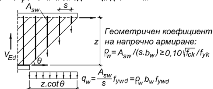
Фиг.5.4. Диагонален ритеров разрез
