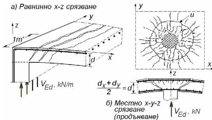
Фиг.7.0. Дефиниране на явленията равнинно и местно срязване
