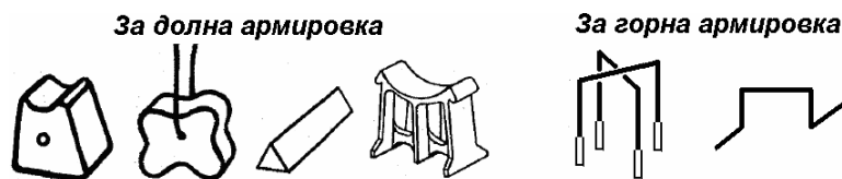
Фиг.10.6. Фиксатори от фибробетон, от пластмаса и от стомана
