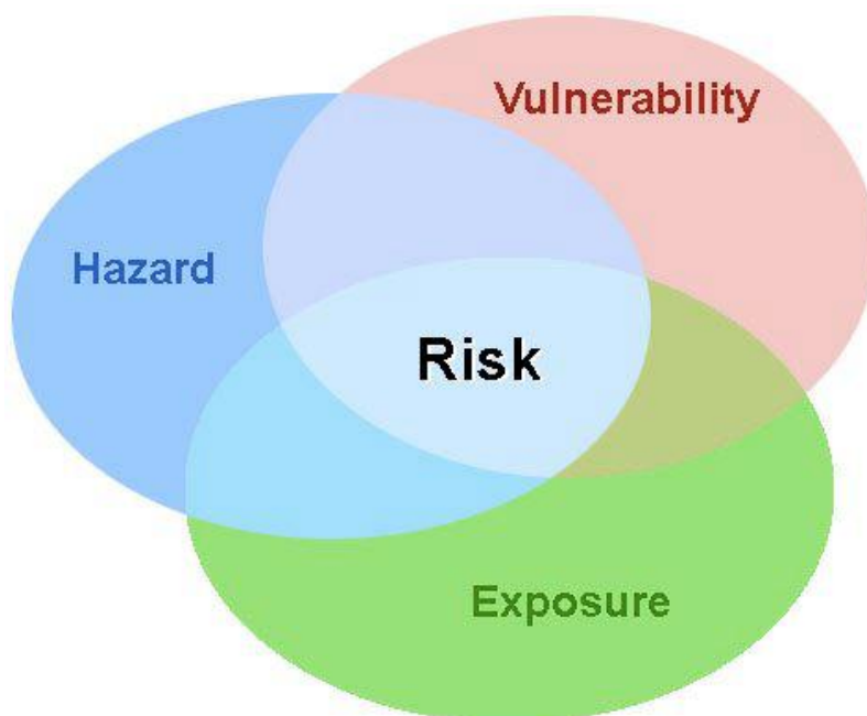
Фигура 1. Илюстрация на дефиницията за: Seismic risk (сеизмичен риск); Hazard : (сеизмична опасност); Exposure (изложеност); Vulnerability (уязвимост)
