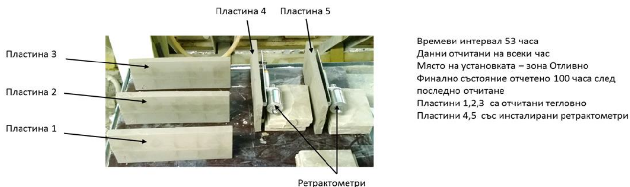
Фиг. 4 Сушене на пластини от суров керамичен материал за производство на санитарен порцелан в околна среда
