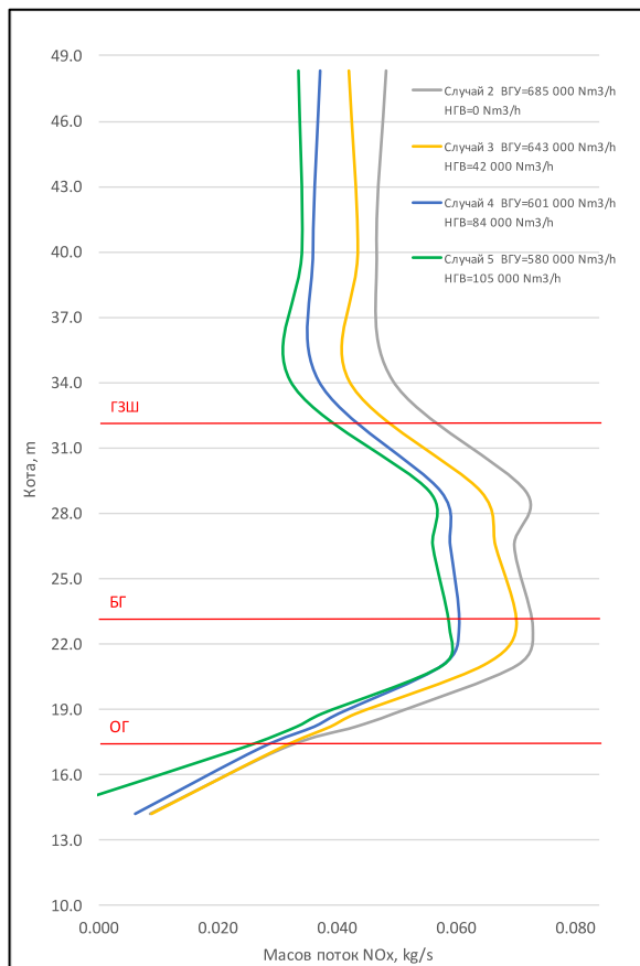
Фиг. 5 Изменение на масовия поток на \text{NO}_x по височина на печната камера, при различен дебит на надгоривен въздух
