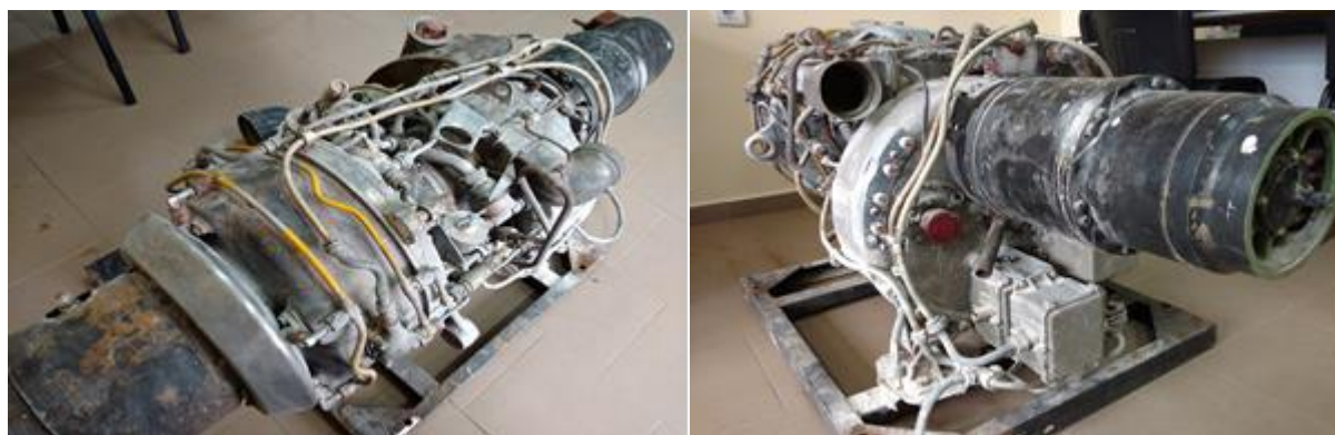
Фиг. 1 Общ изглед на газова турбина ТГ-16М преди възстановяване
