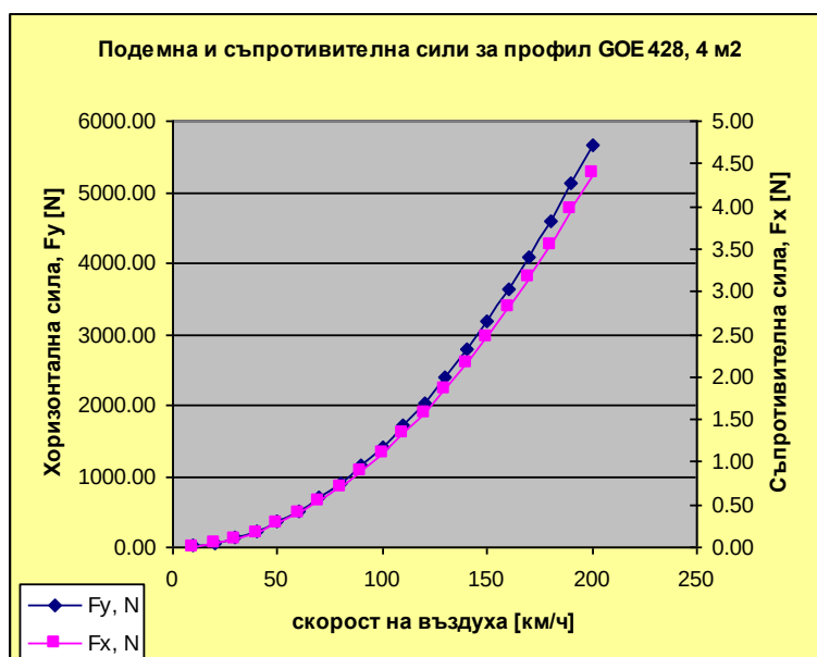
Фиг. 3 Подемна и съпротивителна сили за профил GOE 428 при свободно обтичане
