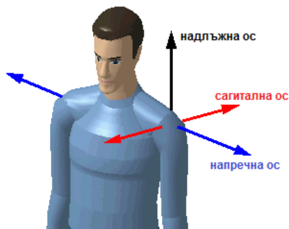
Фиг. 6 Оси на движение на частите на манекена
