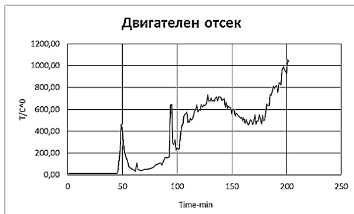
Фиг. 2 Измерени температури в двигателния отсек при затворен капак
