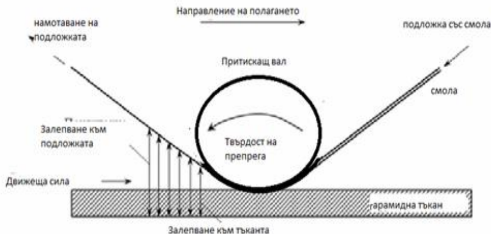
Фиг. 1 Схема на трансфериране на свързващо вещество върху тъкан
