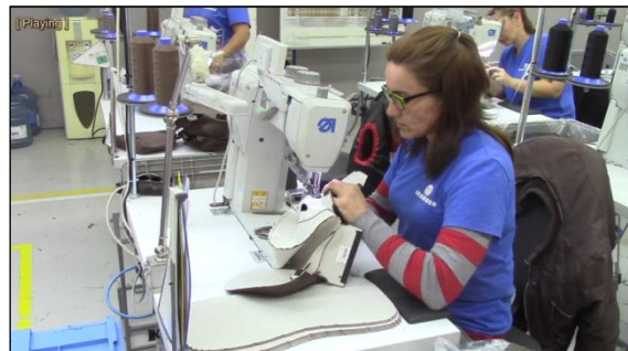
Фиг. 11 Поставяне на детайл 3 в зоната на шиене
