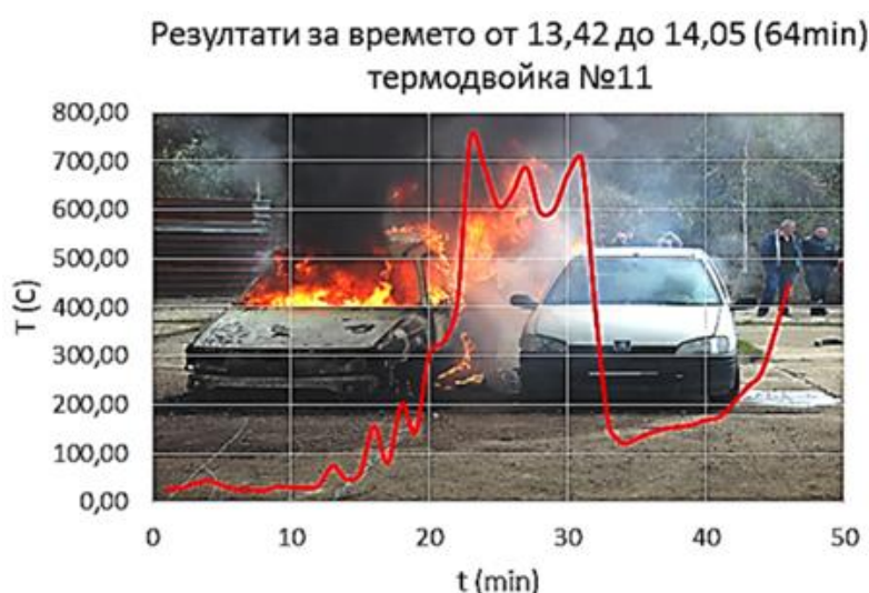
Фиг. 4 Температура от експеримент на термодвойка 11 (пожар) в салон за пътници
