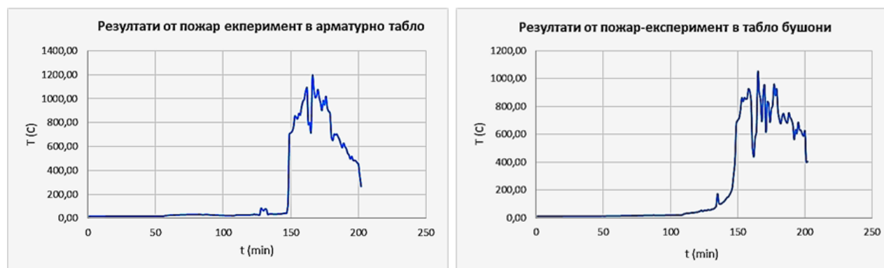
Фиг. 6 а) Експериментални изследвания в арматурно табло; б) Експериментални изследвания в табло бушони
