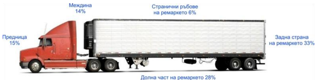
Фиг. 1 Разбивка на аеродинамичните загуби при камионите [3]
