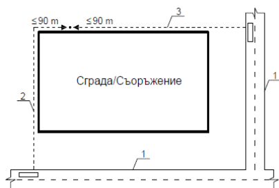
1 - път за противопожарни цели 2, 3 - възможни маршрути за полагане на шлангова линия
